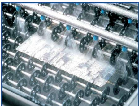
Na radni vek mlaznica utiče njihov napredni dizajn i širok spektar materijala koji se koristi za proizvodnju. Inovativne strukture, mnogi tipovi koji su patentirani, obezbeđuje veću otpornost na začepljenja i produžiti period zamene pogotovo u teškim uslovima eksploatacije.
