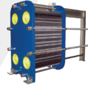
HCGP - PLOČASTI IZMENJIVAČI TOPLOTE izrađeni od nerđajućeg čelika 304/316 zaptiveni EPDM ili drugim materijalima. Koriste se tamo gde ima potrebe za čišćenjem ploča.
