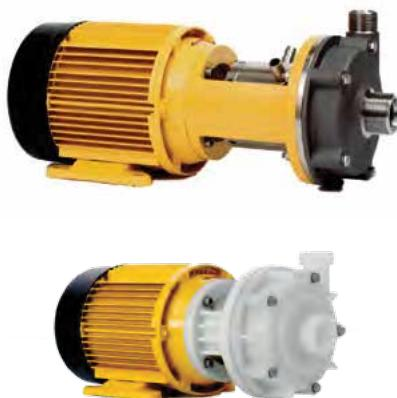
Kod ove serije pumpi, snaga motora se prenosi direktno preko vratila na radno kolo (bez magnetne spojnice). Mehanički zaptivač sprečava neželjena curenja. On je obično jednostruki ali se isporučuje i verzija sa duplim zaptivanjem sa obezbeđenim priključcima za ispiranje.
