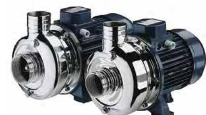
Centrifugalne pumpe sa otvorenim (DWO) i zatvorenim radnim kolom (DWC). **DWO** pumpe nalaze primenu kod ispiranje povrća, mesa, ribe. Takođe, koriste se kod industrijskih mašina za ispiranje, za poliranje metalnih delova, kod sistema za pranje u proizvodnji ambalaže, flaša itd... Pogodne su za pumpanje fluida kod kojih postoje i manje čestice zbog otvorenog radnog kola.
