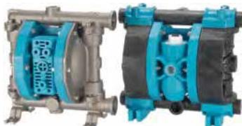
Veliki izbor veličina i varijanti pumpi **ASTRA** koja se proizvodi u veličinama od 1/4" pa do 2". Proizvode se od POMc, PP, PVDF, Aluminijuma, nerđajućeg čelika AISI 316. Podnose temperature fluida od -10°C pa do +80°C.
