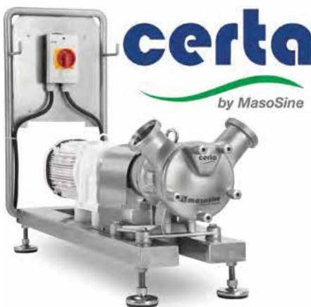
**Jednostavna konstrukcija!** Jedan rotor, jedna osovina, jedan mehanički zaptivač. Nije potrebno vremensko podešavanje, niti merenje tolerancija prilikom montaže. Simetričnost pruža mogućnost promene rotacije tj. funkciju pumpanja u oba smera. Vrsta i položaj prirubnica se može prilagoditi postojećem sistemu prema želji korisnika, tako da nije potrebna nikakva dodatna prepravka cevovoda.
