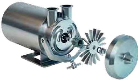
Pumpe tip **HD** odlikuju nežno i tiho pumpanje, kao i odlična usisna moć - samousisna (do 7m). Posebno je pogodna za transport fluida sa primesama gasa. Zbog simetričnog oblika radnog kola moguća je rotacija u oba smera, što je u nekim aplikacijama jako bitno. Jednostavna konstrukcija omogućava brzo i lako održavanje i zamenu zaptivača.
