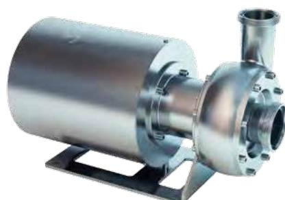
Centrifugalne pumpe **LE** takođe odlikuju nežno i tiho pumpanje, kao i visoka efikasnost zahvaljujući optimizovanoj konstrukciji spiralnog kućišta i geometrije otvorenog radnog kola. Dizajn bez tzv. „mrtvih prostora“ obezbeđuje higijensku upotrebu i brzo čišćenje (CIP i SIP) delova koji dolaze u dodir sa fluidom.
