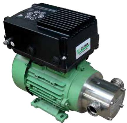
NINOSTAR pumpe su visokokvalitetne pumpe izrađene od nerđajućeg čelika koje nalaze primenu u raznim aplikacijama u industriji. Koriste se kako za abrazivne tako i za blago korozivne medijume. Često se koriste i u prehrambenoj industriji jer su dostupne sa higijenskim priključcima prema DIN 11851. Prodaje se u dosta slučajeva sa integrisanim frekventnim regulatorom na motoru za jednostavno povećavanje brzine ili smera rotacije.
