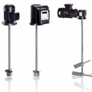
**Električni agitatori** izrađeni su od kvalitetnih materijala i samim tim predstavljaju pravi izbor u procesu pripreme rastvora. Ovim uređajima se može upravljati eksternim signalom ili manuelno. Sa brzinama do 1500 o/min, pogodni su za kontinualne procese mešanja medijuma viskoziteta do 200 mPas i max gustine 1,2 kg/dm<sup>3</sup>.
