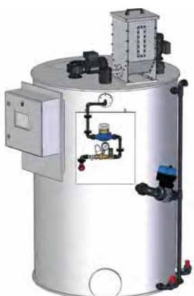
Sistem sa dve komore na dva nivoa. Komore se nalaze jedna iznad druge. Unošenje praškaste materije se vrši sa vrha preko utovarivača praškastih materija. Priprema polimera se događa u gornjoj komori. Nakon definisanog vremena dozrevanja, smeša se preliva u donju komoru i spremna je za upotrebu.
