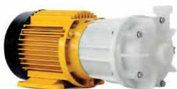
Od osnovnog modela MPN izvedena je verzija perifernih pumpi model P, namenjenih za aplikacije gde se zahteva mali protok pri povišenom naporu. Rotor je dizajniran kao regenerativno radno kolo turbine, koji omogućava povišen pritisak i skoro linearnu karakteristiku (protok - napor).
