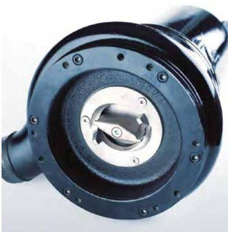
Model Barracuda GRP se izdvaja po tome što je na usisu instaliran specijalni sistem sečiva (ASC), koji u deliću sekunde usitni krupne komade. Izbegava se zaglavljivanje pumpe, a na potisu su dovoljne cevi manjeg prečnika, što zнатно smanjuje troškove kompletne investicije.
