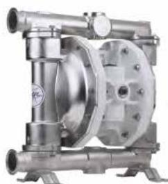
Pumpe **ASTRA FOOD** su prilagođene za pumpanje prehrambenih proizvoda i u potpunosti zadovoljavaju FDA standarde, s obzirom da su delovi izrađeni od elektropoliranog nerđajućeg čelika AISI 316 sa 125 Ra finiširanjem i od PTFE sertifikovanog za prehrambenu namenu. Maksimalni viskozitet medijuma je 50.000 cP. Podnose temperature fluida do +95°C.
