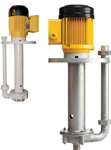
Takozvane drenažne vertikalne pumpe izrađene su od plastičnih i metalnih kise-lootpornih materijala. Elektromotor je postavljen na postolju iznad rezervoara, a osovina je povezana sa hidraulikom koja je potopljena.
