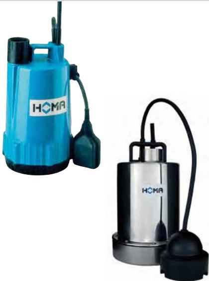
Drenažne pumpe se obično koriste za ispumpavanje vode iz podruma, šahtova, rezervoara, za suzbijanje poplava ili podzemnih voda u građevinskim poduhvatima, uklanjanje vode iz vodotokova ili akumulacija. Puma se isporučuje sa plovkom (prekidačem) radi zaštite od rada na suvo. Uz pomoć plovka voda se može drenirati do 2mm.
